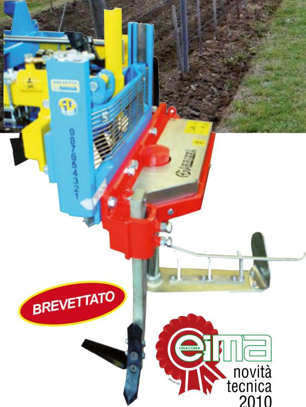
**■** Sistema di salita e discesa su guide: consente di spostare in modo indipendente le 2 parti lavoranti abbassandole di 20 cm (utensile interfila e DX e utensile interfilare SX). L'attrezzo può essere utilizzato per la lavorazione combinata di un filare e di una (o entrambe) le zone interfileri.
