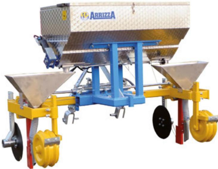
■ INTERRATORE DI CONCIME AD ALLARGAMENTO IDRAULICO
