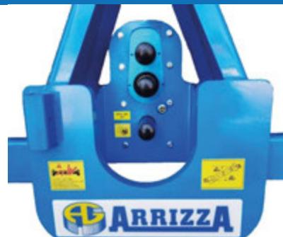
**■** Quarta presa di forza anteriore 540 g/min SX (necessità della reversibilità completa di attacco a 3 punti anteriore/posteriore e tripla presa di forza con cardano CODE 1362)Q
