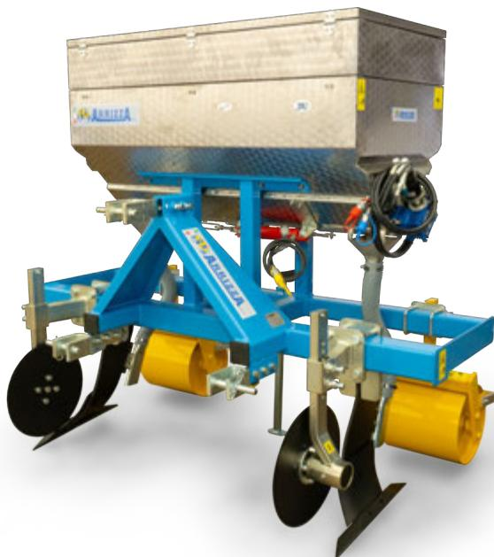
■ INTERRATORE DI CONCIME ED ARIEGGIATORE A REGOLAZIONE MECCANICA DELLA LARGHEZZA DEL TELAIO
