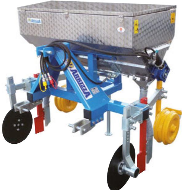
■ INTERRATORE DI CONCIME A REGOLAZIONE MECCANICA DELLA LARGHEZZA DEL TELAIO
