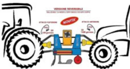
**■** Reversibilità completa di attacco a 3 punti anteriore/posteriore e tripla presa di forza con cardano: posteriore 540 g/min DX e anteriore 540 g/min DX + 1000 g/min SX (non applicabile su versioni 1XS, 1S, 1 e telescopiche)
